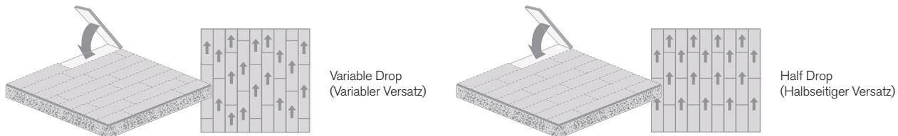
Unter Beibehaltung der Verlegerichtung auf der Senkrechten können Skinny Planks mit halbseitigem Versatz auf der Längsseite der Planke (Ashlar oder Half Drop) oder auch mit variablem Versatz auf der Längsseite (Variable Drop) verlegt werden, wobei der variable Versatz speziell bei Microtuff-Produkten bevorzugt wird.
