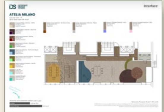
英特飞设计工作室提供的平面图 涵盖碳影响信息
